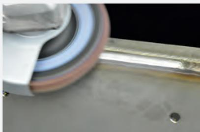
Schweißnahtabtrag und attraktives Finish in einem Arbeitsgang
