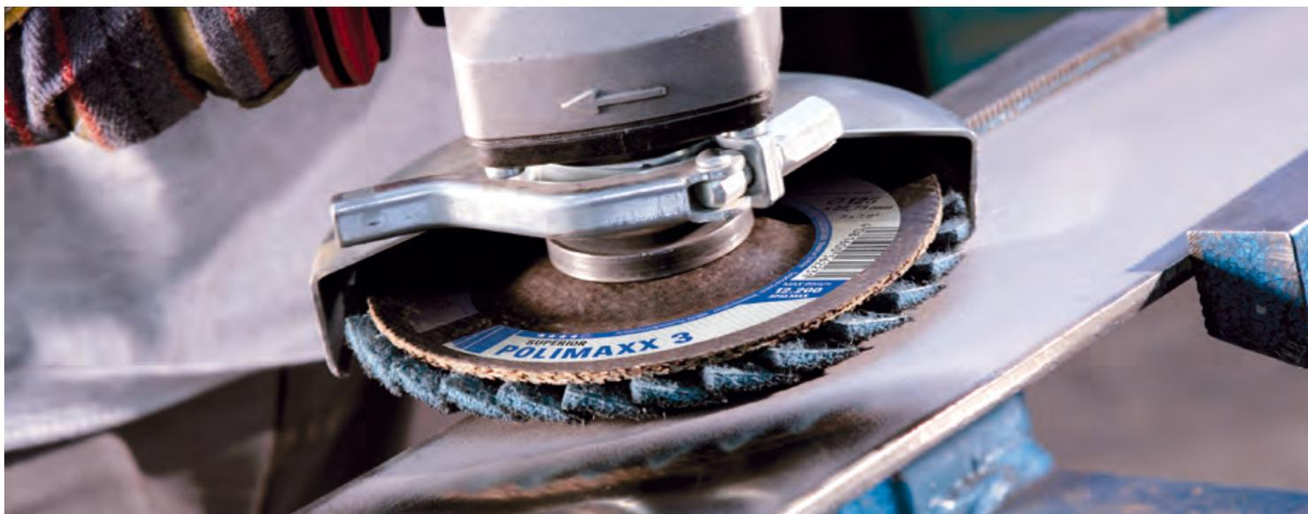
DRONCO-Polierfächerscheiben liefern durch ein innovatives, hochwirksames Schleifvlies in fächerförmiger Lamellenstruktur herausragende Ergebnisse bei der Bearbeitung von Edelstahl, Stahl, Aluminium und NE-Metallen.
